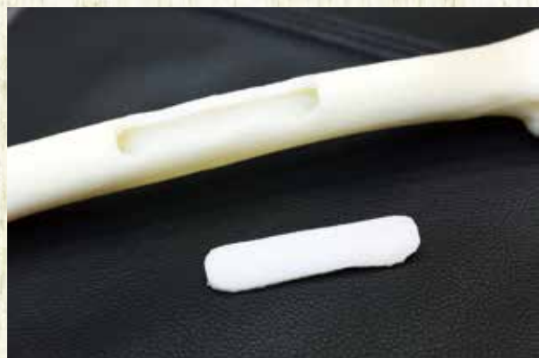
系統可調校 HA 和 PCL 的混合比例，以打印適用於不同骨折位置的植入物。
